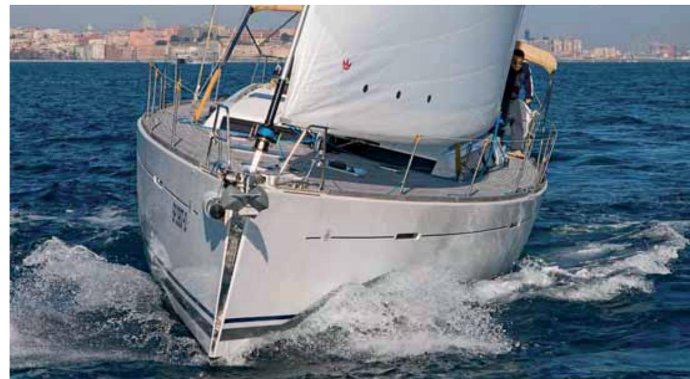
Di aspetto massiccio, il Dufour 485 ha ottime doti veliche e di tenuta di mare. Una carena potente con volumi immersi contenuti, la poppa alta e una prua verticale, consentono un passo morbido e velocità di rilievo
