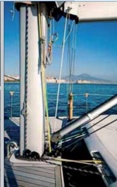
In alto, un particolare delle manovre che, uscite a piede d'albero, "scompaiono" sotto traccia lungo la tuga. In primo piano la lunga finestratura. Sotto, la doppia timoneria che separa le due aree del pozzetto
